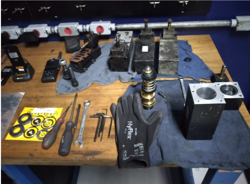
Figura 14: Limpeza das válvulas dos flaps .
