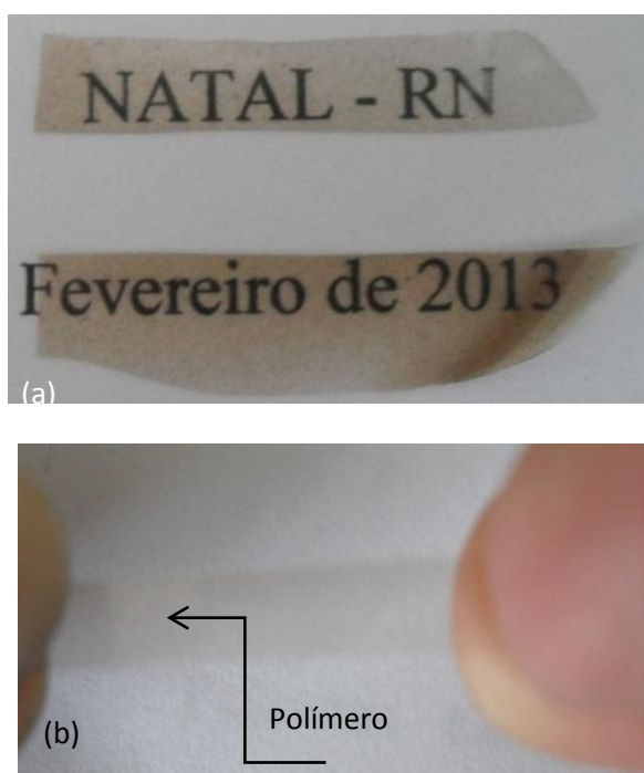
Figura 49 - Fotos do polímero obtido destacando sua coloração e sua transparência (a) na imagem (b) destacando sua deformação elástica quando submetido a esforços trativos.
