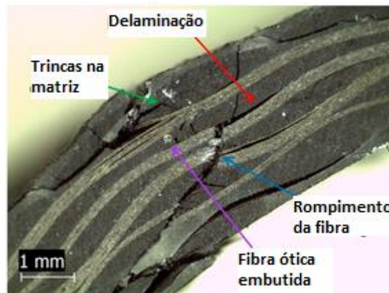
Figura 3.4 – Falhas em um compósito laminado (Neha et. al. , 2017).
