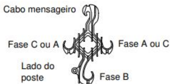
Figura 3 – Espaçador losangular para Rede Compacta (Spacer).
