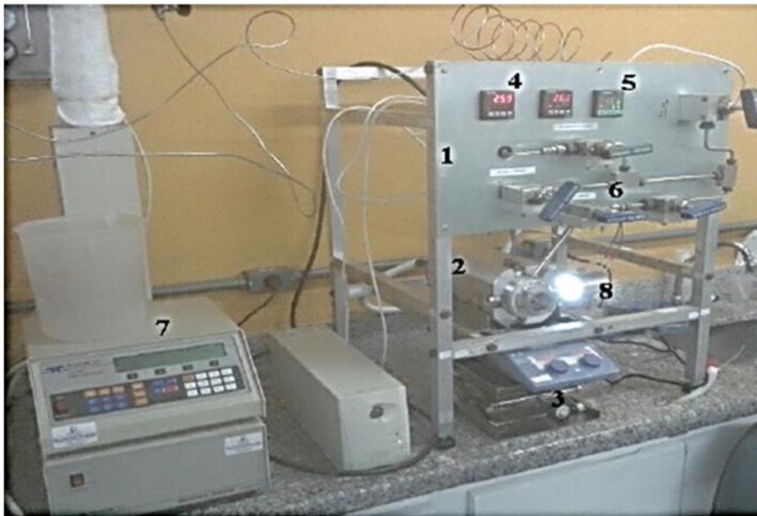
Figura 3.3 - Sistema de medição de equilíbrio a alta pressão. (1) suporte universal, (2) célula de pressão, (3) agitador, (4) termopar, (5) pressostato, (6) válvulas micrométricas, (7) bomba seringa, (8) fonte luminosa.
