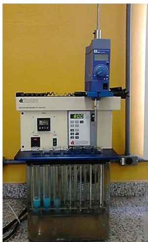
Figura 3.1 - Equipamento utilizado nos ensaios de remoção – Water Separability Tester
