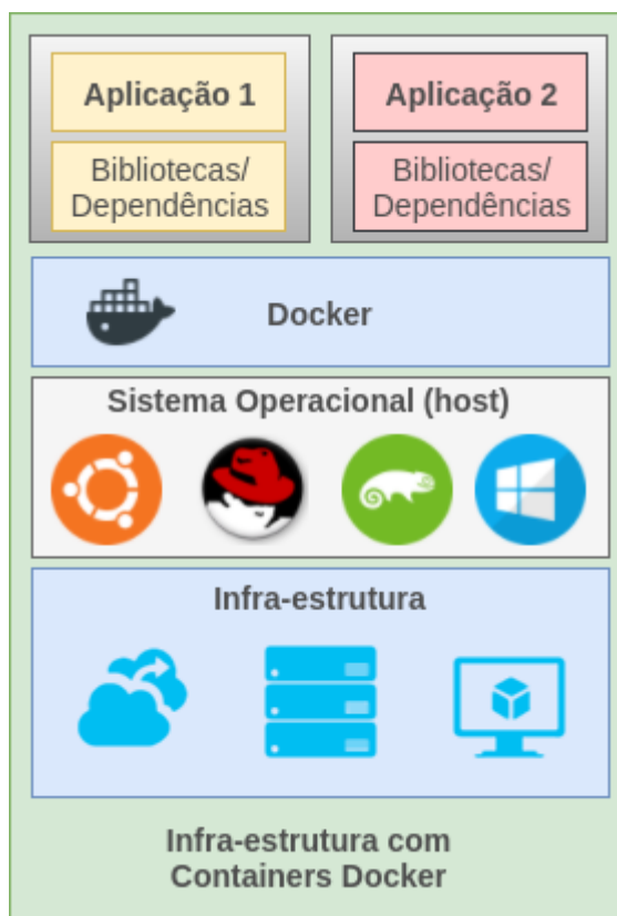
Figura 3 – Estrutura para Contêineres
