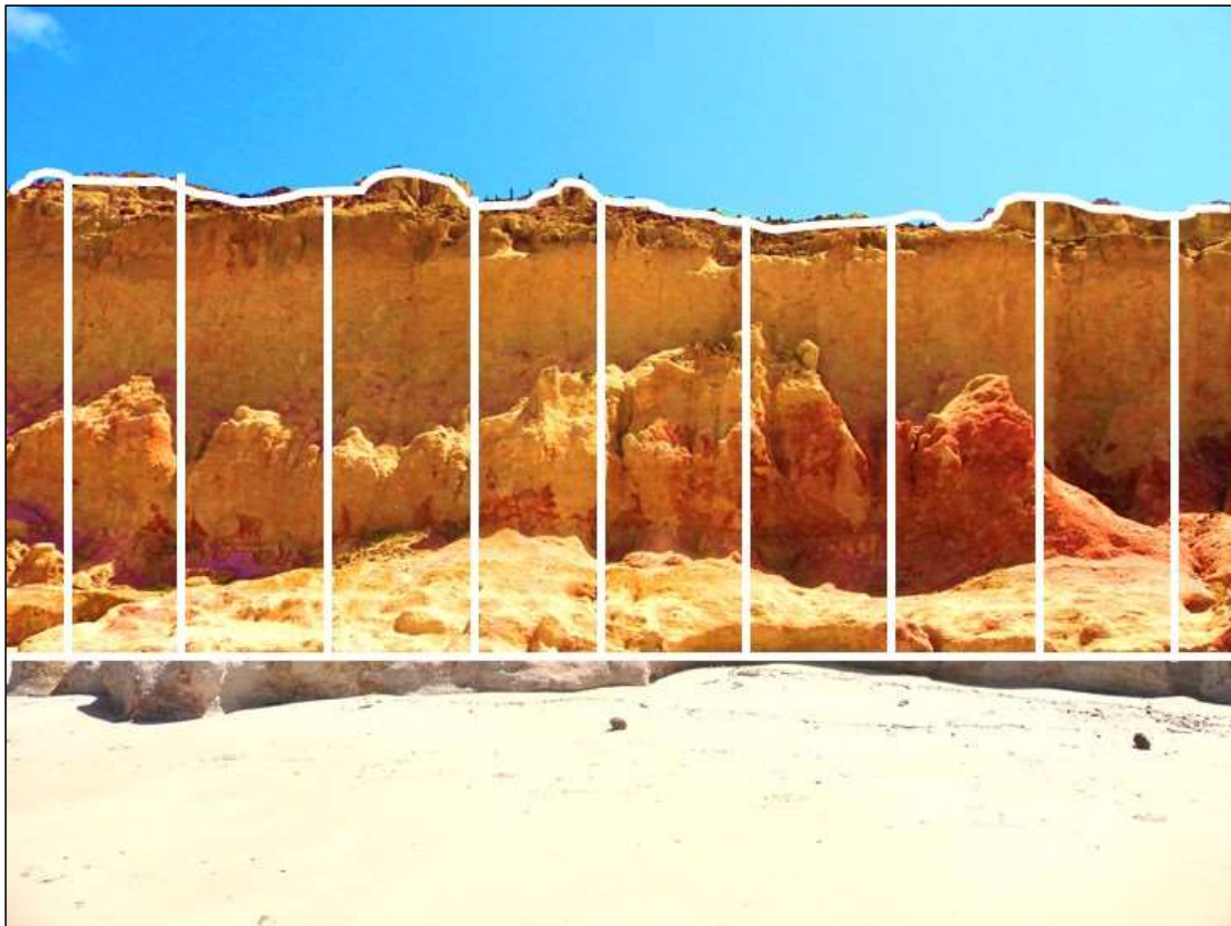
Figura 3.10 - A seção hachurada representa o setor da falésia marinha acima da cota +3,0m utilizada para a comparação entre os levantamentos realizados em 21/08/2016 e 24/02/2017.
