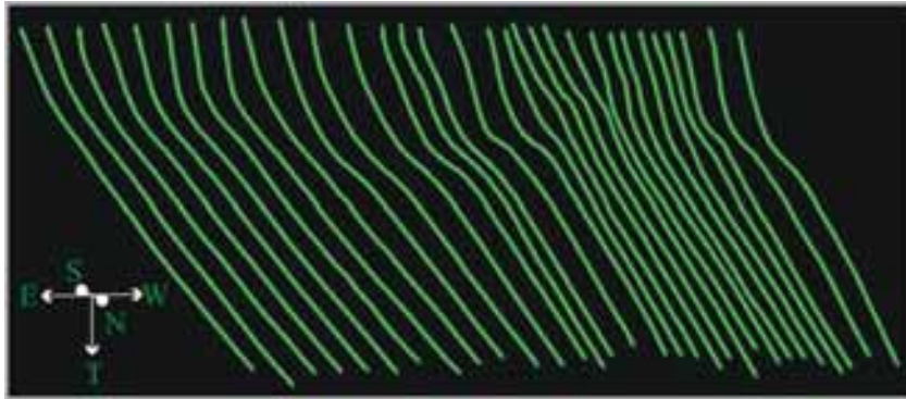
Figura 9.14 - Imagem 3D do domínio V da Falha de Baixa Grande, gerada com uso do software SeisVision, ilustrando seu padrão geométrico. No domínio V o plano da falha apresenta mergulho moderado e é caracterizado por uma geometria lítrica.
