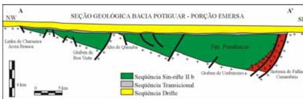
Figura 3.4 – Seção geológica cruzando a porção emergida da Bacia Potiguar (modificado de Matos, 1999).
