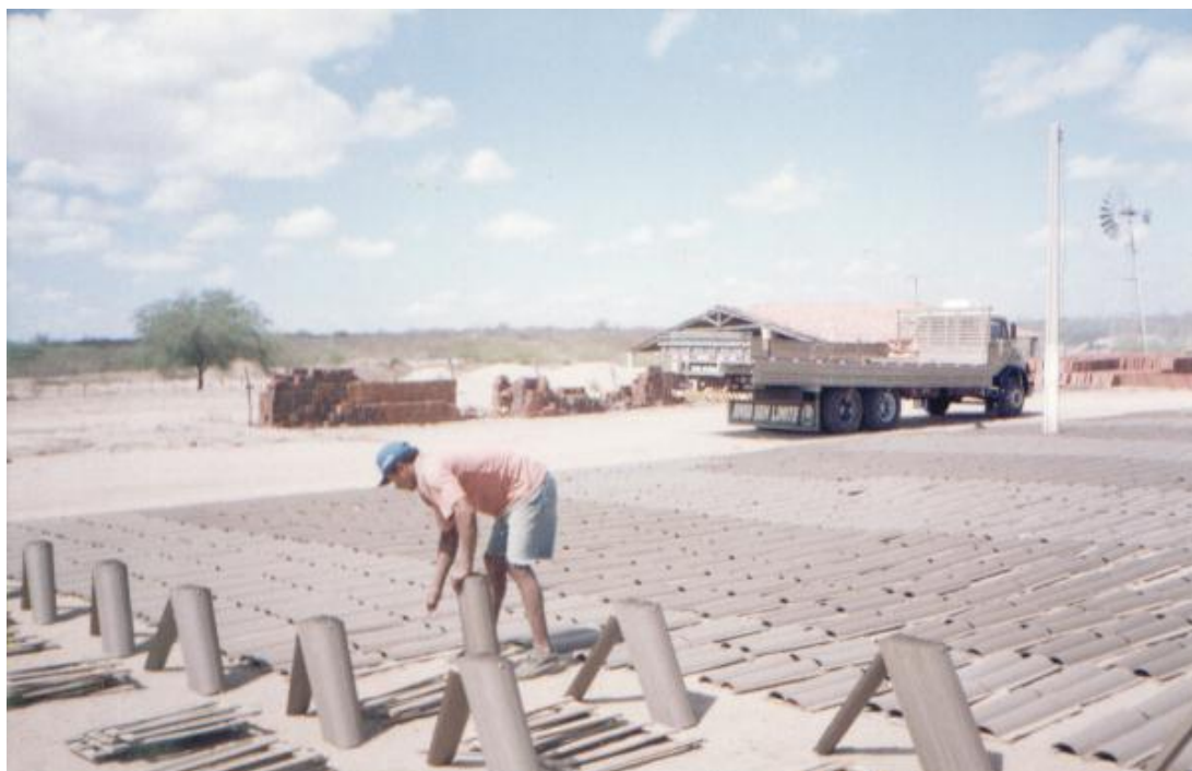
Figura 28: Retirada das telhas do pátio de secagem
