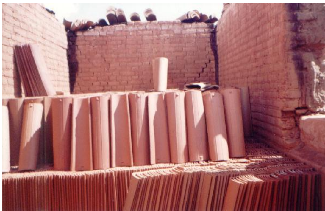
Figura 31: Aspecto do interior de um forno ainda com o produto recém-cozido
