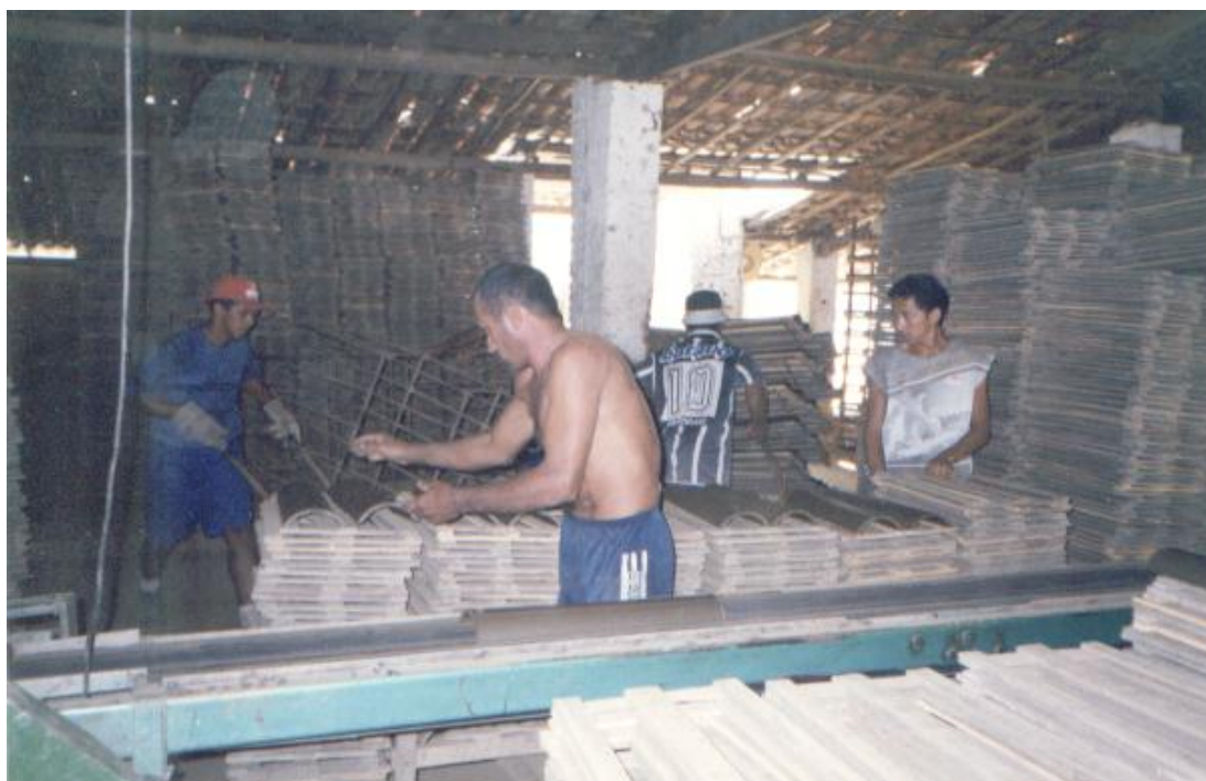
Figura 24: Telhas saindo da maromba para o pátio de secagem
