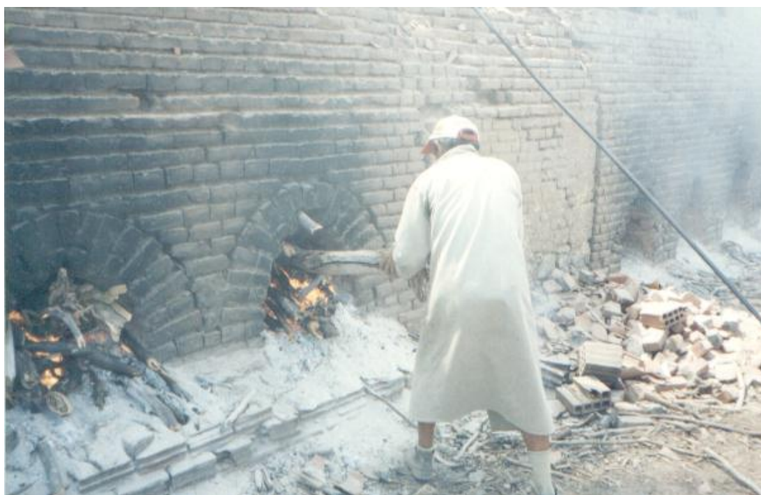
Figura 30: Operador alimentando os fornos com lenha
