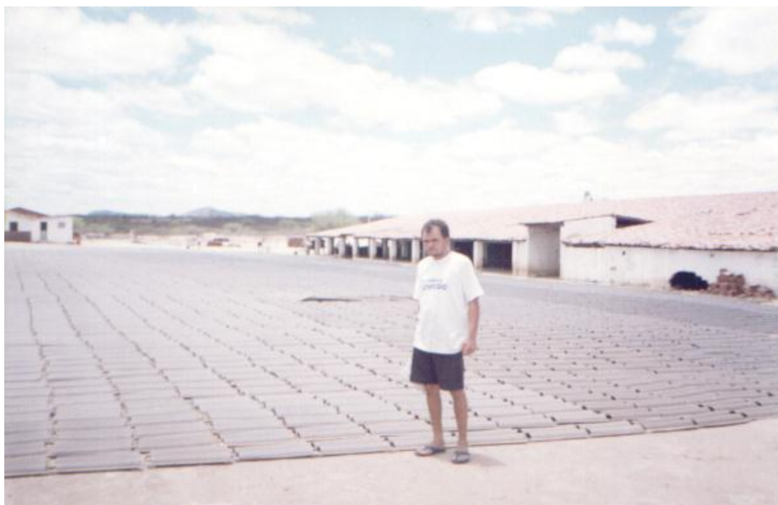
Figura 27: Secagem de telhas ao ar livre
