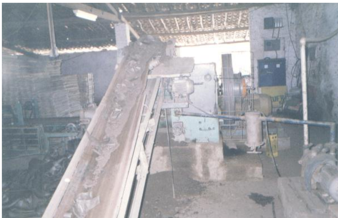
Figura 22: Esteira transportando o laminado para a maromba
