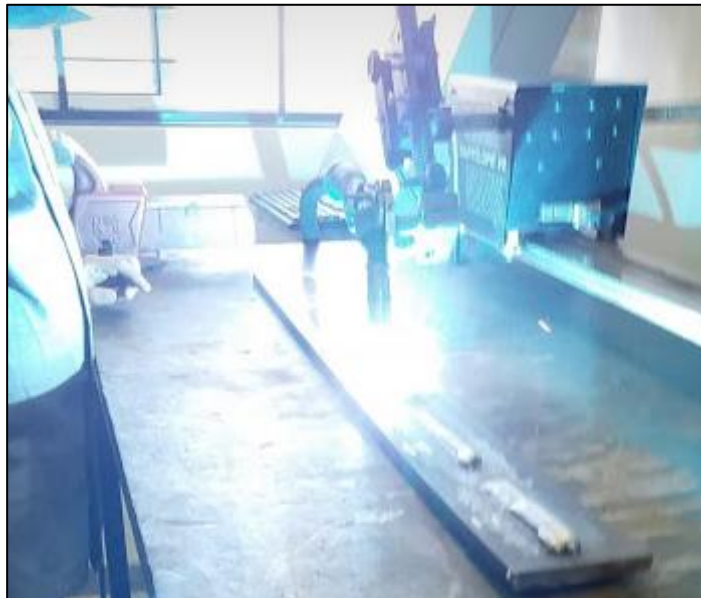
Figura 23. Deposição do revestimento Inconel 625 e Inox 309L através da soldagem MIG utilizando o TARTÍLOPE V1.
