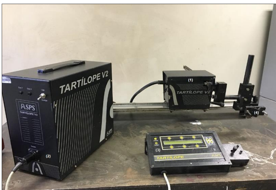
Figura 22. Equipamentos empregados no procedimento automatizado de soldagem. Componente de deslocamento linear (1); fonte do sistema de deslocamento linear de soldagem (2); controlador de variáveis do sistema (3); garra de fixação da tocha (4).
