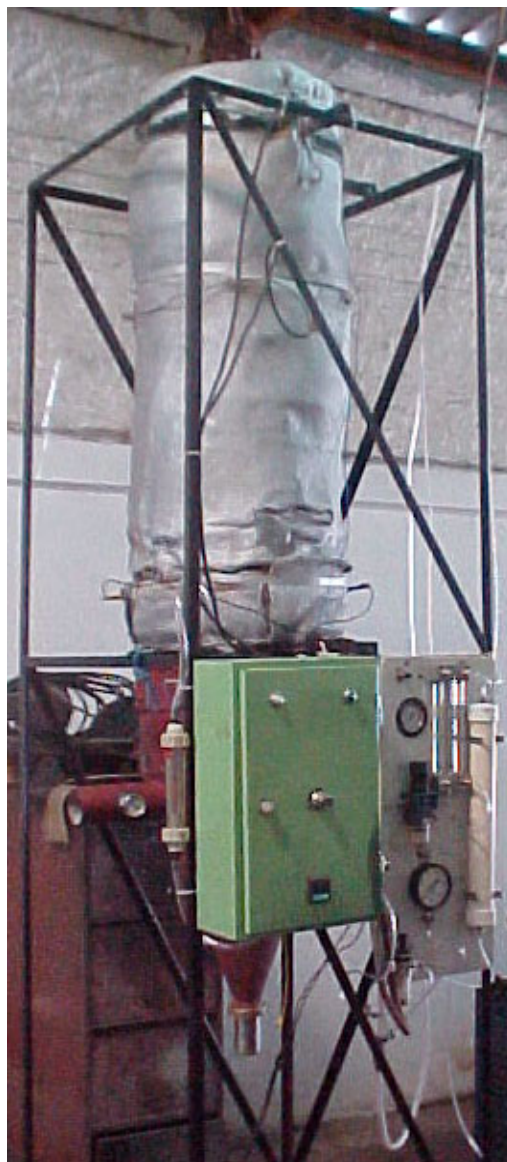
Figura 4.3 - Dispositivo experimental completo - secador “spray”
