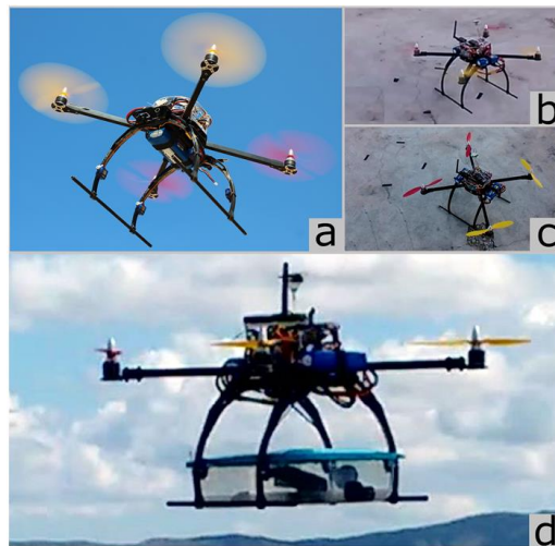
Figura 23. Testes de voo do UAV K-263 (a) modo de voo Loitter (b) take-off (c) pouso autônomo (d) delivery box acoplada com carga.
