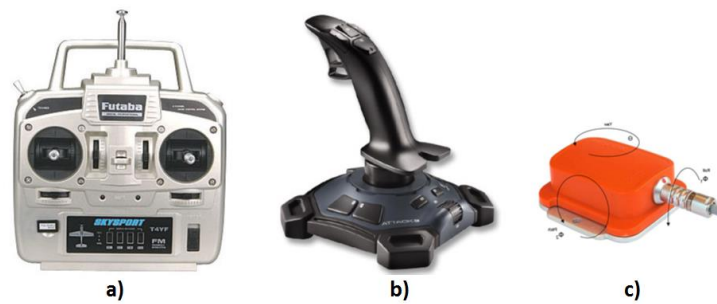
Figura 10. Interfaces utilizadas por [77] – a) Rádio transmissor; b) Joystick e c) IMU.
