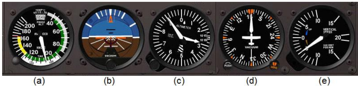
Figura 7. Principais elementos de uma GUI de uma GCS (a) velocidade do ar, (b) horizonte simulado (c) altímetro (d) bússola e (e) variômetro.
