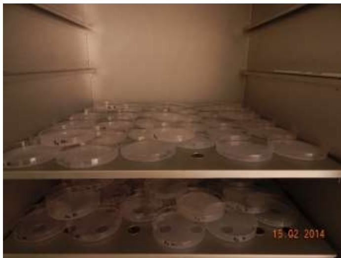
Figura 3. 3. Secagem dos biofilmes de extrato de facheiro e fécula de mandioca em placas de polipropileno.
