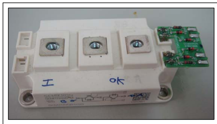
Fig. 4.6 – Vista ilustrativa do módulo IGBT SKM200GB125D de SEMIKRON®
