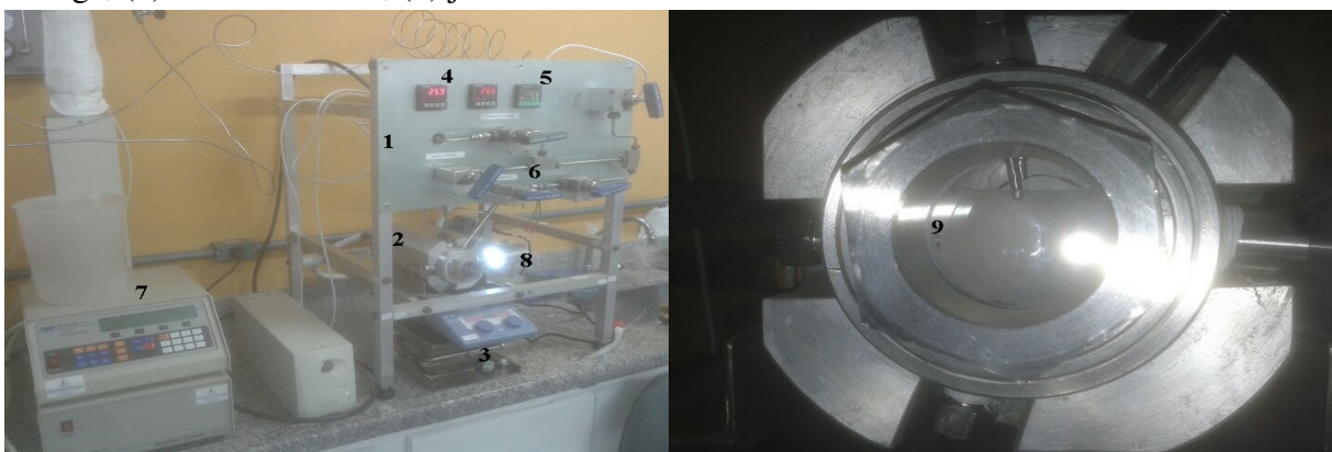
Figura 3.5. Sistema de medição do equilíbrio a alta pressão. (1) suporte universal, (2) célula de pressão, (3) agitador, (4) termopar, (5) pressostato, (6) válvulas micrométricas, (7) bomba seringa, (8) fonte luminosa, (9) janela de safira.
