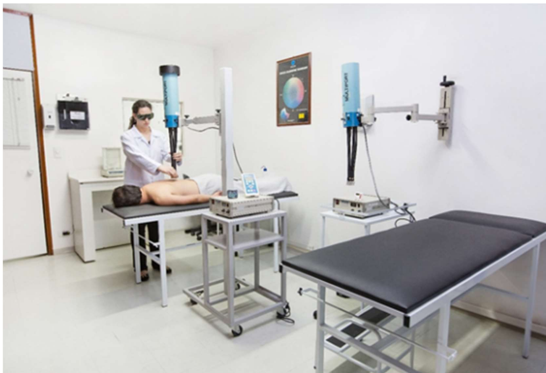
Figura 13 – Equipamento para determinação do fator de proteção solar in vivo
