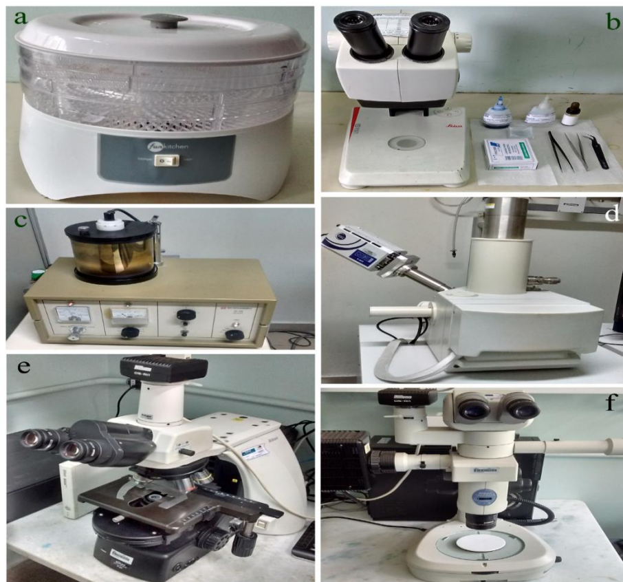
Figura 14 – Equipamentos e materiais empregados na identificação e herborização dos espécimes: a) Desidratador elétrico; b) Estereomicroscópio Leica EZ4 e materiais e corantes utilizados na confecção de lâminas para a microscopia; c) Aparelho metalizador usado na MEV; d) Microscópio Eletrônico de Varredura; e) Microscópio óptico Nikon Eclipse NiR1; f) Estereomicroscópio Nikon SMZ 1500. Fotos: autor.
