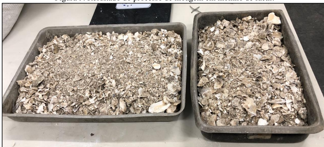
Figura 9. Resultado do processo de moagem em moinho de facas.
