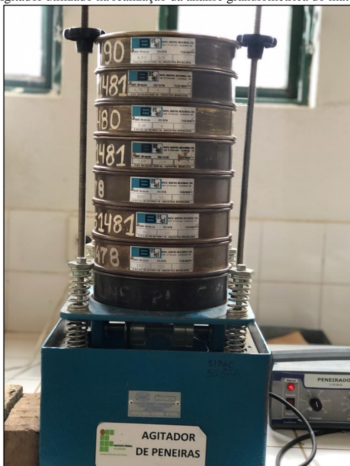
Figura 10. Agitador utilizado na realização da análise granulométrica do material.
