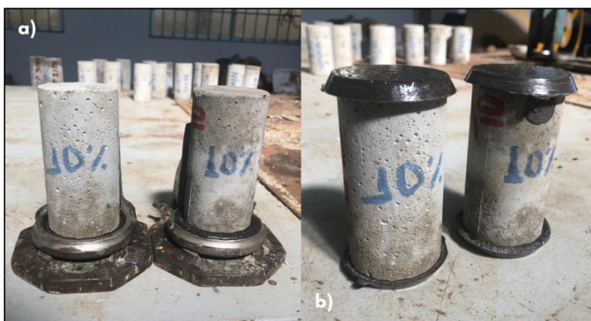
Figura 11 (A). Corpos de prova em base com enxofre durante o capeamento; (B) corpos de prova capeados.
