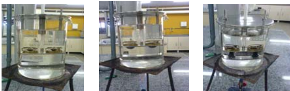
Figura 4.8. Ensaio de ponto de amolecimento empregando o equipamento Deltex – 1.586-D.
