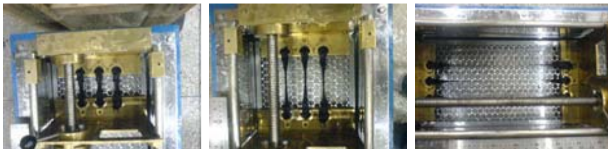
Figura 4.9. Ensaio de ductilidade utilizando o equipamento ductilômetro Pavitest.
