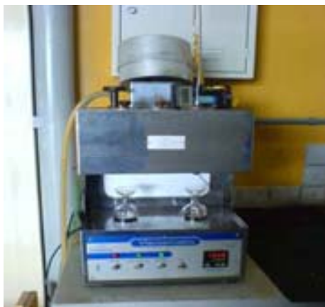
Figura 4.7. Ensaio de viscosidade utilizando o viscosímetro Saybolt Furol. (Pavitest Novus N480D).
