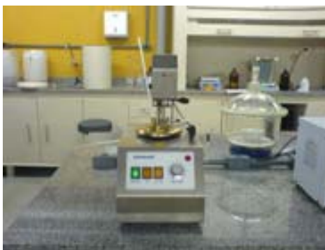
Figura 4.6. Ensaio de ponto de fulgor empregando o equipamento para ponto de fulgor (Petrotest-Modelo 12-1660).
