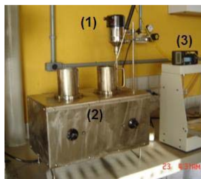
Figura 4.3. Sistema utilizado na modificação do Cimento Asfáltico de Petróleo (CAP).
