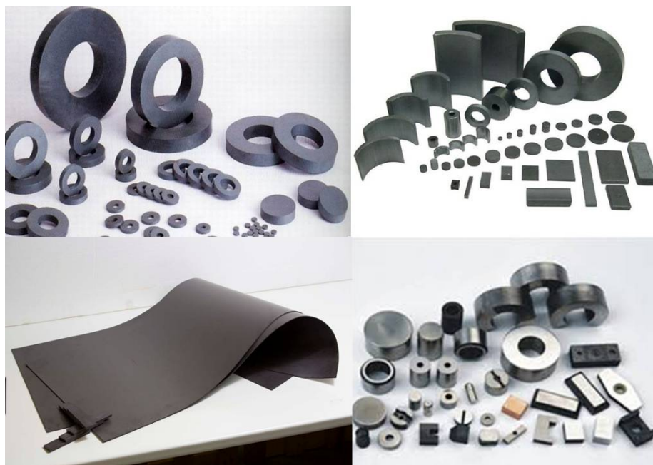
Figura 3.10: Ímãs permanente constituídos de ferritas.
