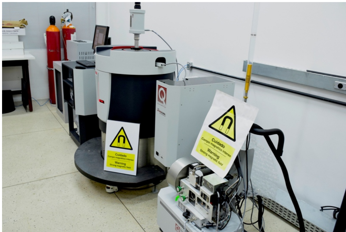
Figura 4.9: Sistema de Medidas de Propriedades Magnéticas do Laboratório de Altos Campos e Baixas Temperaturas DFTE-UFRN.
