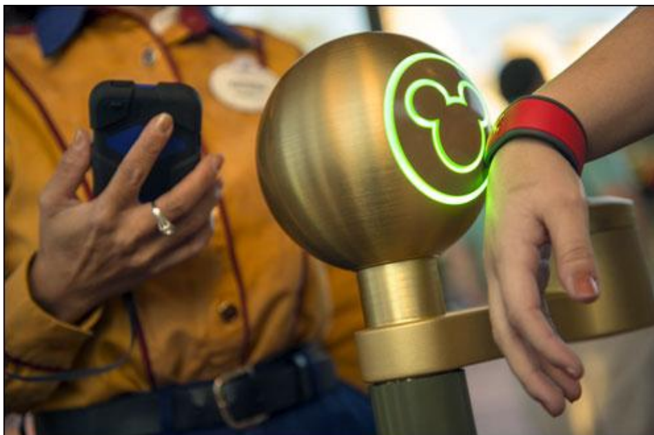
Figura 2.35 - Exemplo de um leitor RFID portátil (na mão do funcionário); de uma pulseira RFID ( MagicBand ) e um leitor RFID usados no Walt Disney World ® [26].
