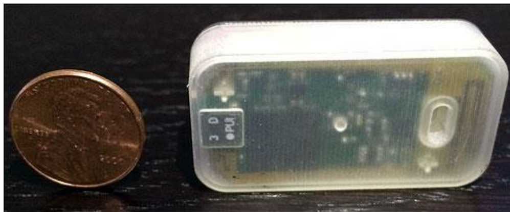
Figura 2.6 - Exemplo de etiqueta RFID ativa encapsulada [17].
