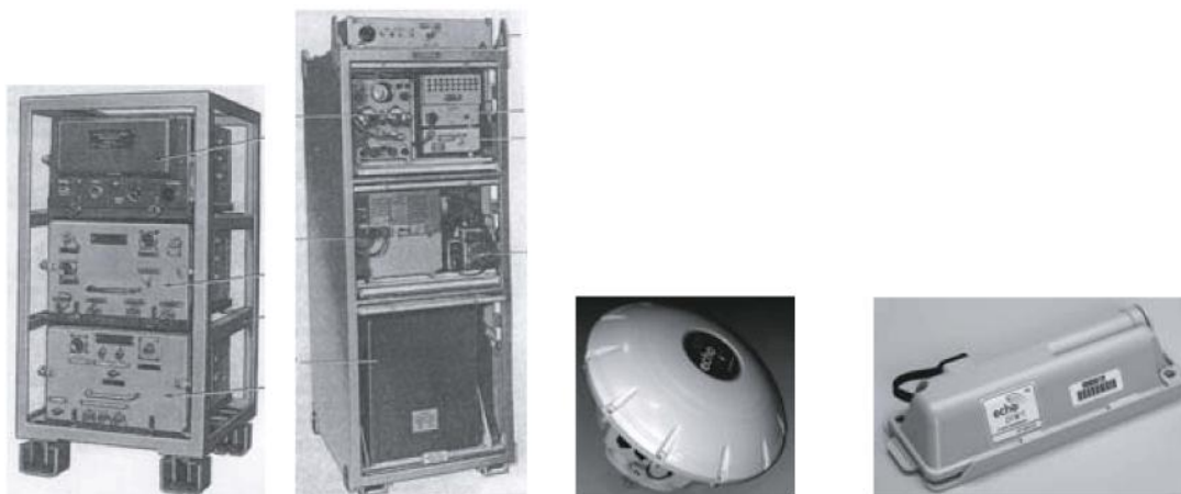
Figura 2.1 - Interrogador e transponder usados no IFF (à esquerda); e usados em RFID (à direita) [3].
