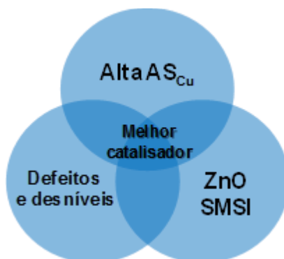
Figura 18: Representações esquemáticas das características necessárias para a síntese de um catalisador de metanol de alto desempenho.
