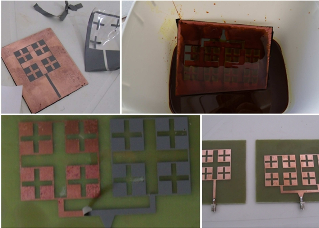
Figura 5.2: Algumas etapas da confecção da antena e arranjo
