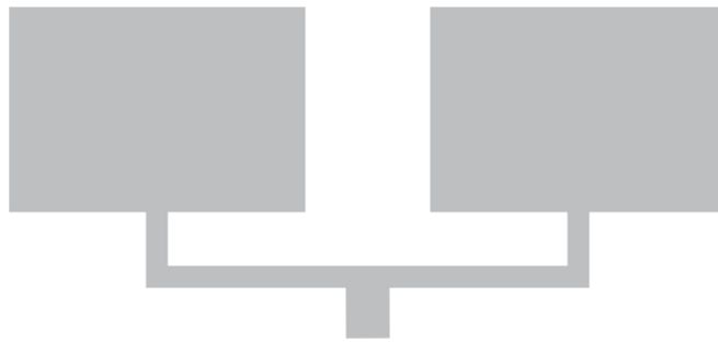
Figura 3.1: Representação de um arranjo linear em microfita com dois patches retangulares
