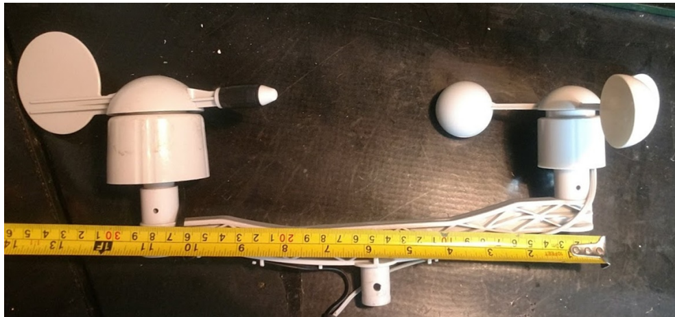
Figura 5.5: Biruta e anemômetro utilizados no projeto.
