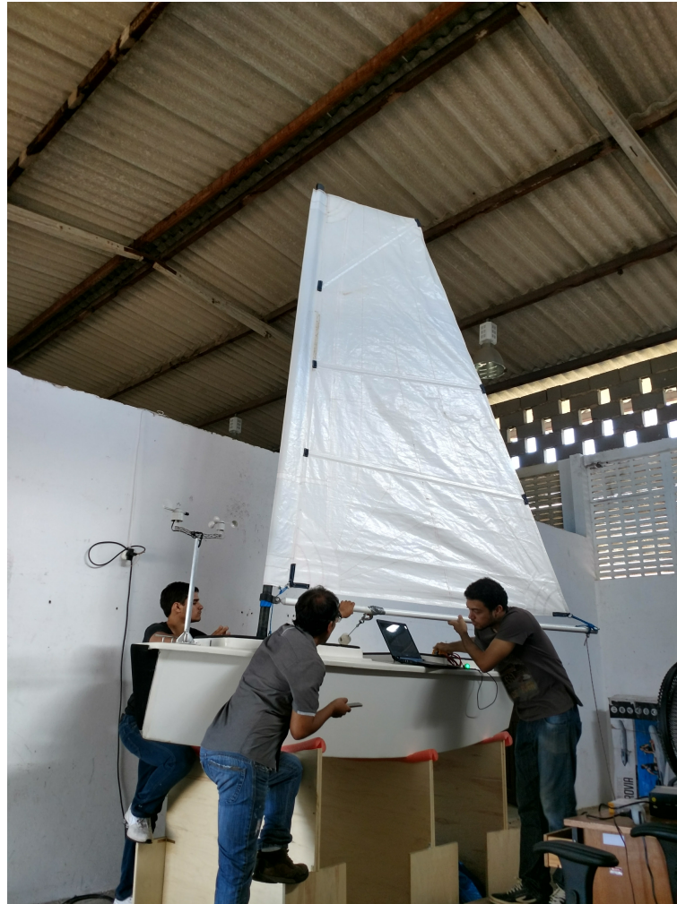
Figura 6.4: Teste laboratorial do N-Boat II em software-in-the-loop .
