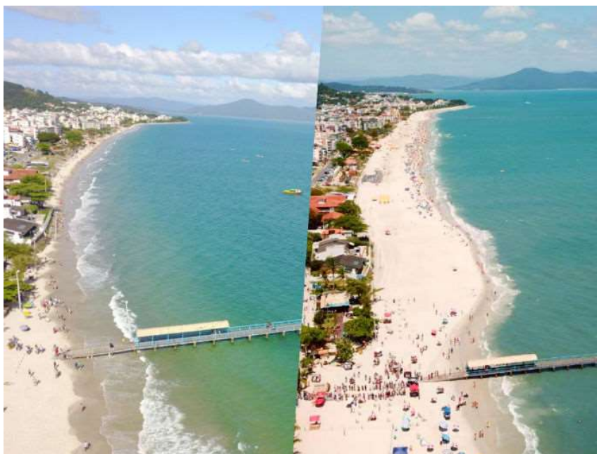
Figura 9: Antes e depois da obra de engordamento da praia de Canasvieiras/SC.
