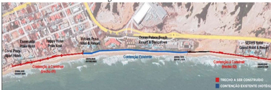
Figura 74: Trechos de construção do enrocamento complementar da praia de Ponta Negra e Via Costeira/RN
