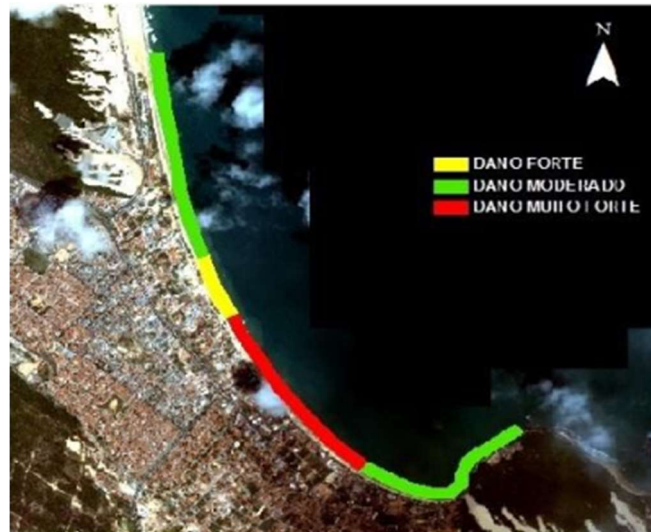
Figura 68: Classificação de danos da erosão na Praia de Ponta Negra
