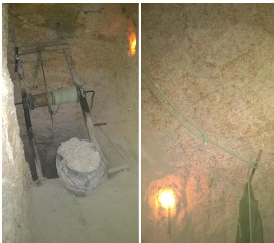
Figura 14. Carretel artesanal e iluminação através de velas dentro da mina.
