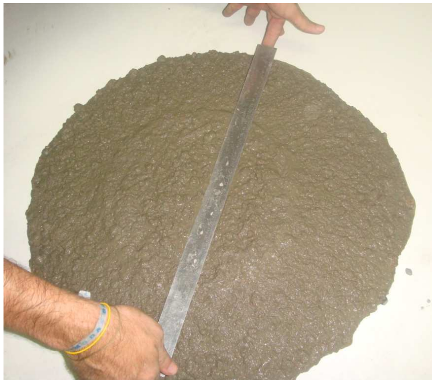
FIGURA 5.19 – Medição do diâmetro de espalhamento ( slump-flow test ).
