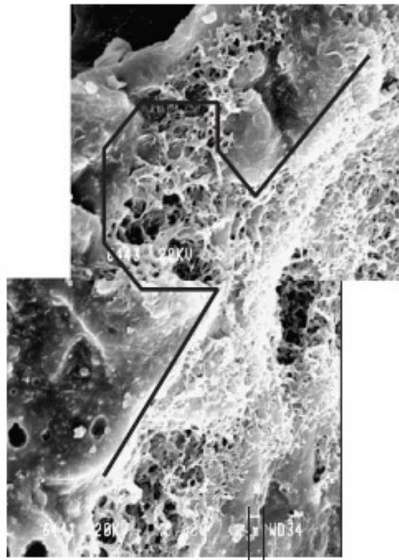
FIGURA 3.8 – Efeito de entrelaçamento entre dos poros do agregado e a pasta cimentícia circundante (LO e CUI, 2004).
