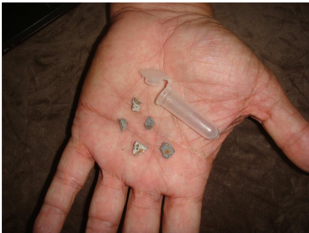
FIGURA 4.7 – Fragmentos de concreto para ensaio de MEV.
