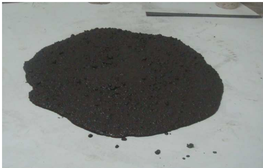
FIGURA 5.20 – Ensaio de espalhamento ( slump flow t_{500} ).
