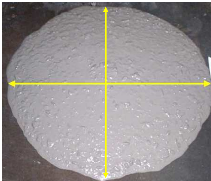
FIGURA 2.18 – Medição do diâmetro de espalhamento (MANUEL, 2005).
