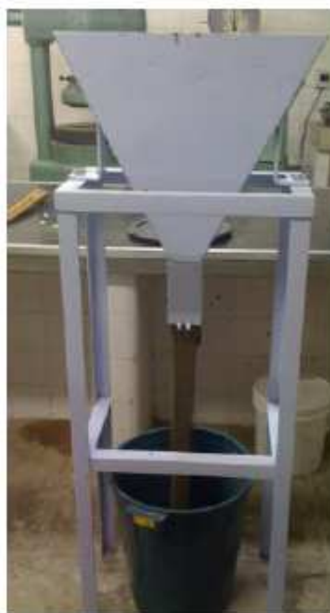
FIGURA 5.21 – Ensaio de escoamento - funil “V”.
