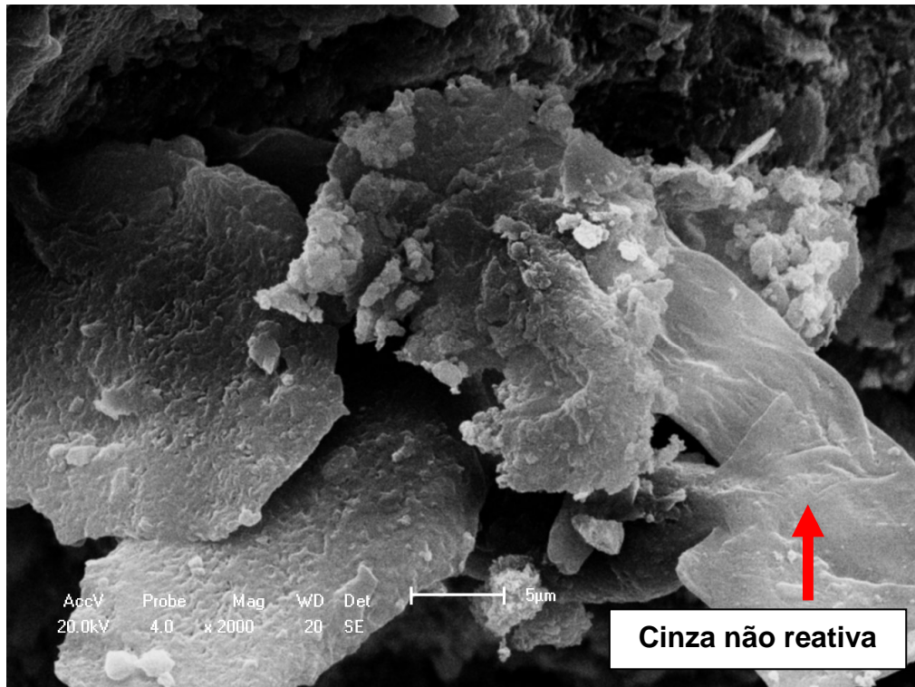
FIGURA 5.39 – Micrografia eletrônica por varredura do concreto CELA 00M-20C.
