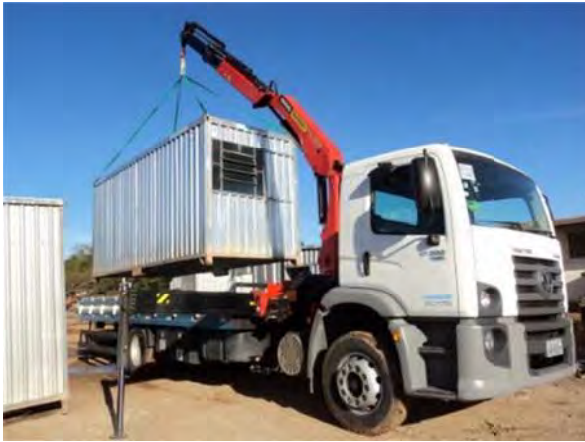
Figura 179 – Caminhão munck 24250 Volkswagen Constellation erguendo container de 20”
