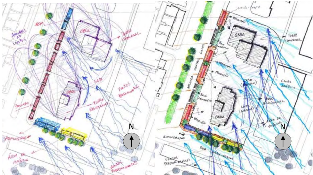
Figura 187 – Croquis da implantação. Desobstrução do pátio da obra e zoneamento das áreas de produção (retângulos vermelhos), administração (retângulos azuis) e vivência (retângulos amarelos) de acordo com a ventilação. Criação das baias para concretagem das torres
