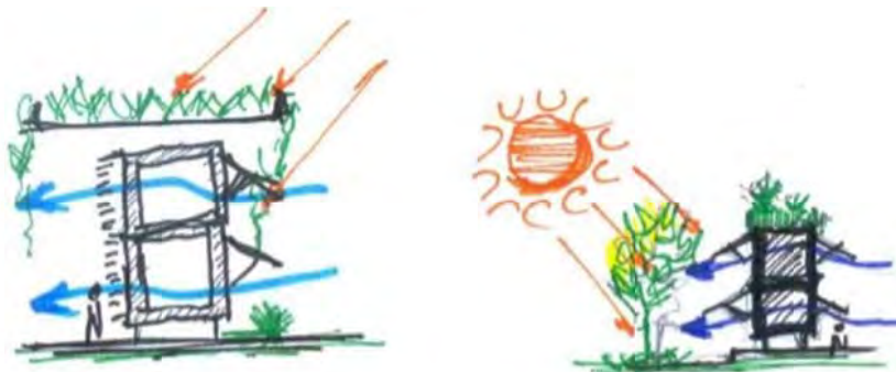
Figura 191 – Laterais livres para a instalação de janelas que permitam a ventilação cruzada – elevações
