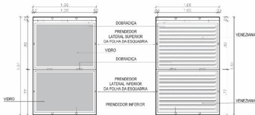
Figura 214 – Folhas da esquadria, unidas ao montante - folha interna (vidro) e folha externa (veneziana) – elevação frontal
