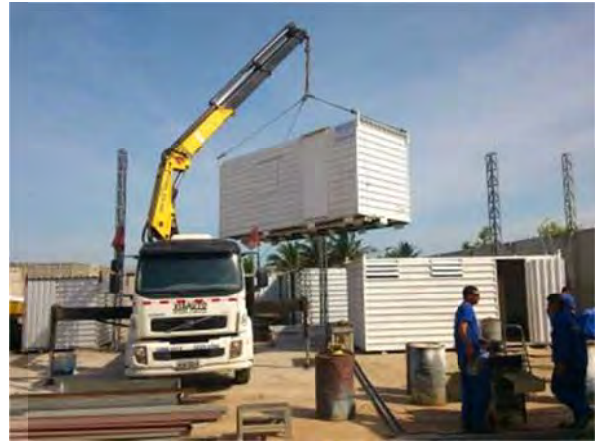
Figura 180 – Caminhão munck Volvo VM 260 F14500 cabine simples erguendo container de 20”
