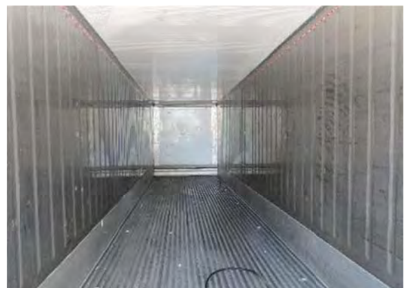
Figura 178 – Vista interna do container refrigerado de 40 pés
