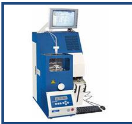
Figura 10. Unidade automática de destilação ADU 4+ (Petrotest)
