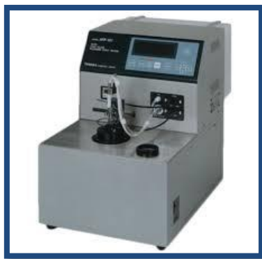
Figura 9. Ponto de entupimento de filtro a frio AFP-102 (Tanaka)
