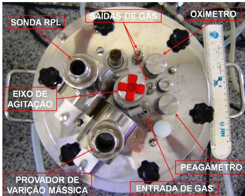
Figura 3.5 – Vista da parte superior da célula (tampa) mostrando a posição de cada componente.
