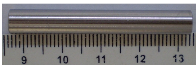
Figura 3.1 – Imagem de um dos corpos de prova e/ou eletrodos de trabalho em aço carbono 1018.
