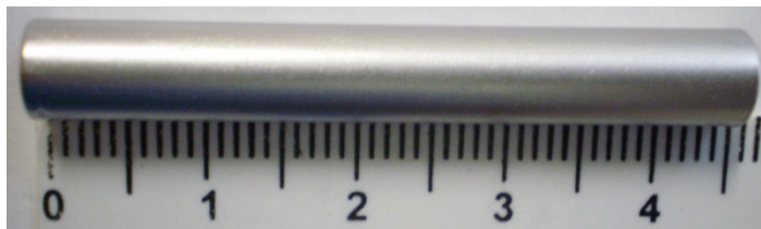
Figura 3.2 – Imagem de um dos contra eletrodos e/ou eletrodos de referência em aço inoxidável 304 L.
