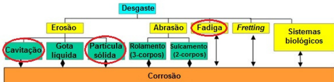
Figura 2.1 – Possíveis interações entre corrosão e os vários mecanismos de desgaste (adaptada de WOOD, 2007).
