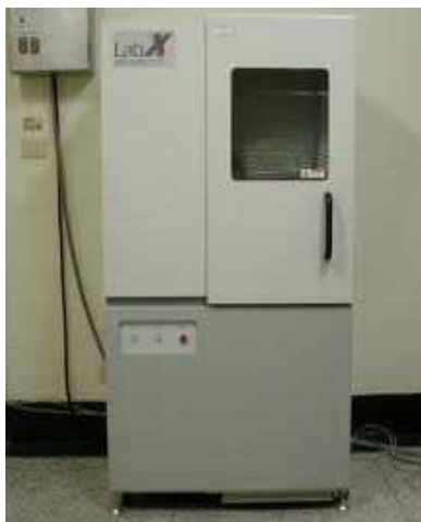
Figura 14 – Difratorômetro de raios-x, modelo XDR-6000, Shimadzu.
