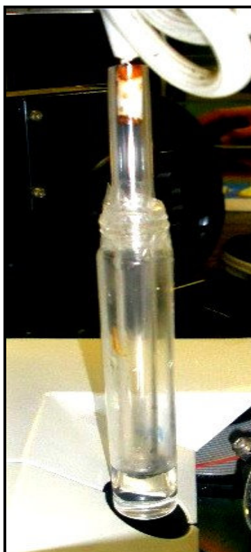
Figura 25 - Sistema de coleta dos gases produzidos pela decomposição do sulfato ferroso.
