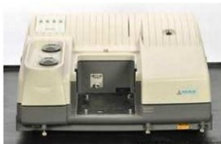
Figura 13 – Equipamento Thermo Nicolet, modelo Nexus 470 FTIR.
