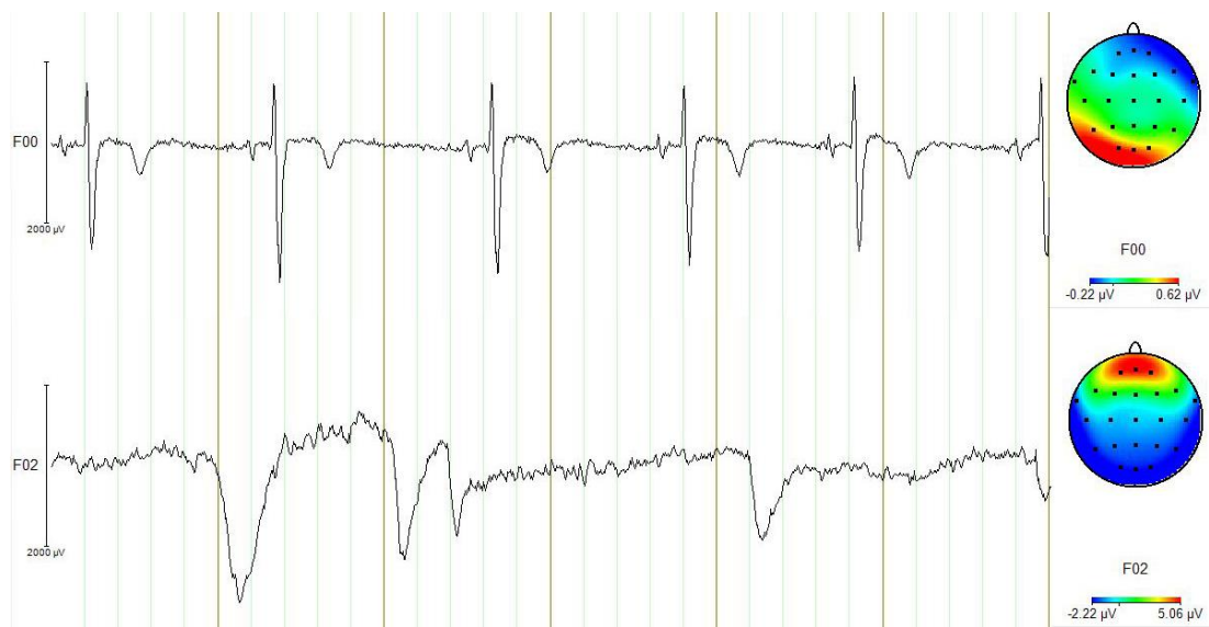
Figura 4 - Dois exemplos de componentes excluídos do sinal de EEG durante o ICA. O primeiro componente (F00) mostra o sinal cardíaco, enquanto o segundo (F02) apresenta movimentos oculares.
