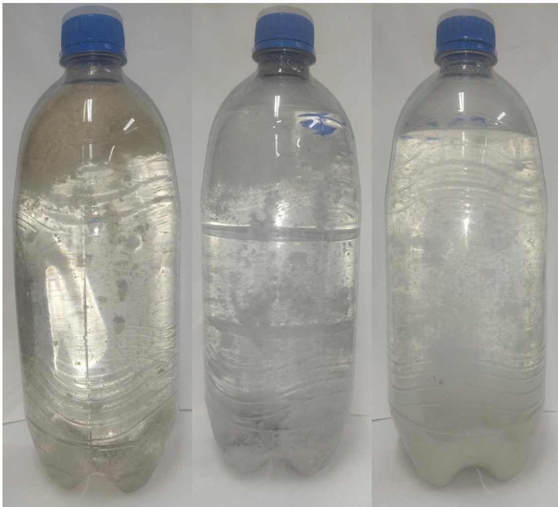
Figura 4.3 – Fotos da formação de alguns precipitados depois do tratamento.
