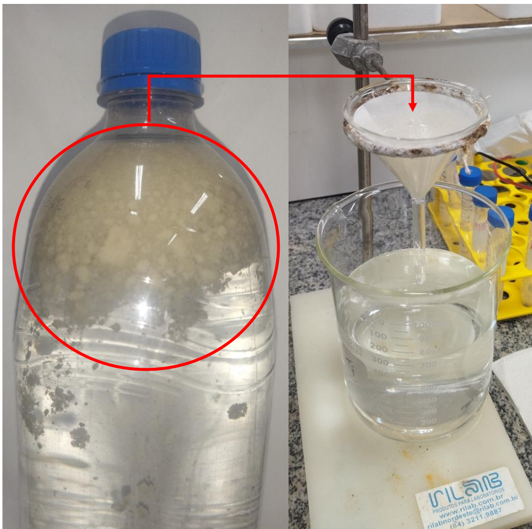
Figura 4.4 – Fotos da formação de alguns precipitados depois do tratamento.
