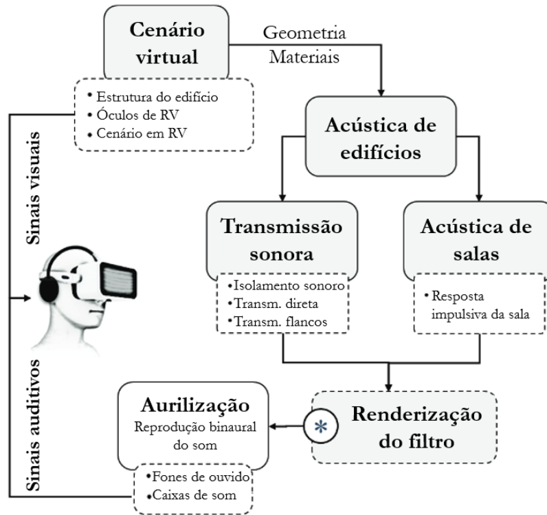
Figura 9 - Processo de aurilização e implementação em RV, quando considerada a acústica de edifícios.
