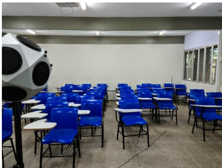
Figura 20 - Foto da sala de aula C05 durante medição de resposta impulsiva com microfone na Posição P 02 .
