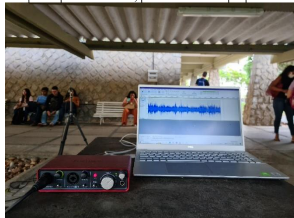
Figura 29 - Sistema utilizado para gravação do áudio composto por microfone, placa de som e laptop.
