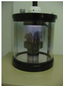
Figura 49 - Banho de ouro nas amostras para coleta de imagens no MEV.
