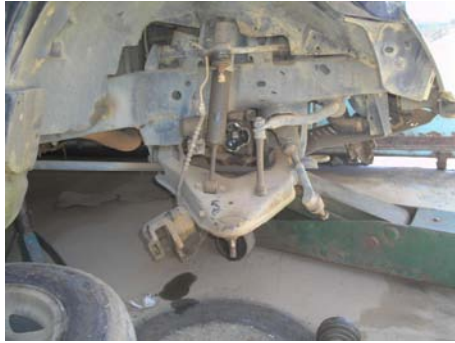
Figura 59 - Vista inferior suspensão dianteira direita, ponta de eixo desmontada
