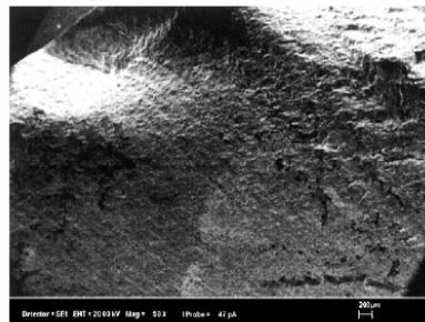
Figura 35 - Marcas de rio e propagação das microtrincas [10].
