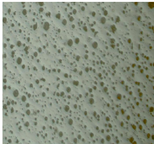
Figura 88 - Peça fraturada sem ataque, nódulos de grafita e matriz. Microscópio ótico 50x.
