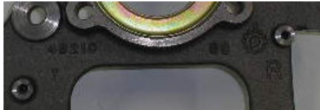
Figura 63 – Inscrições em alto relevo na ponta de eixo da peça estoque.
