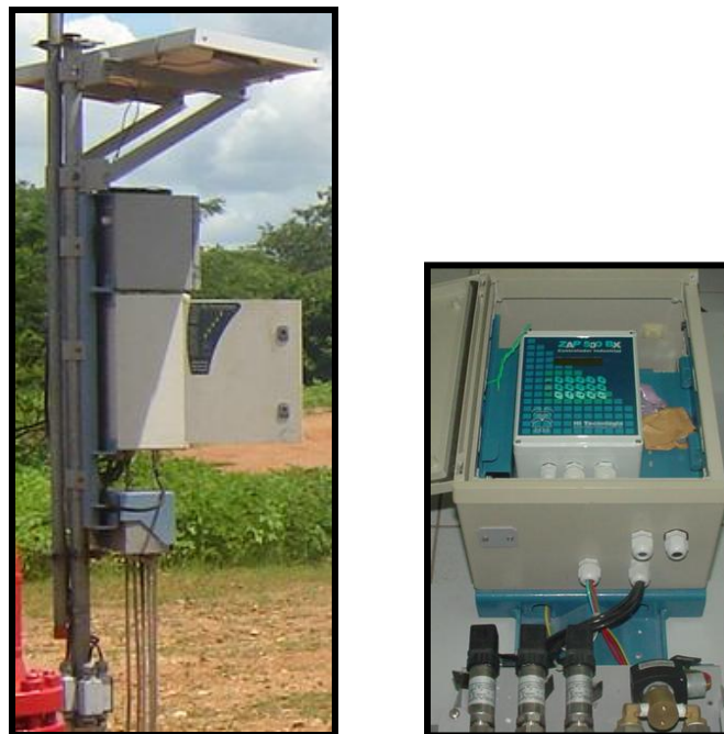
Figura 2.6. Fotos da Unidade Remota e os instrumentos conectados a mesma.
