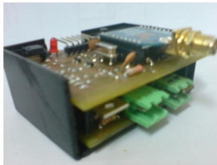
Figura 4.8. Placas componentes do módulo de comunicação.
