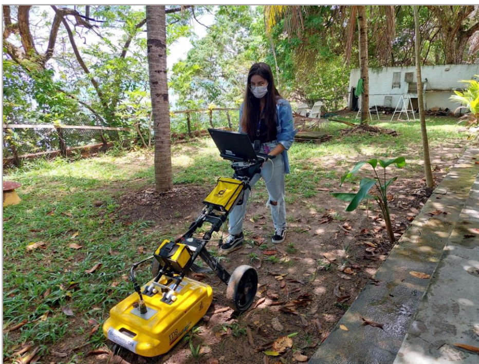
Figura 38: Equipamento Ground Penetration Radar (GPR), modelo Detector Duo da empresa italiana Ingegneria Dei Sistemi (IDS), propriedade da Polícia Federal. Fonte: Autora (2022).
