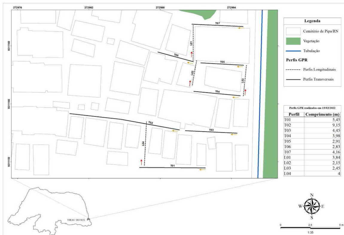
Figura 41: Mapa esquemático com a disposição dos perfis GPR realizados no primeiro dia de campo, na porção do cemitério, com destaque para a direção das linhas L (vermelho) e T (laranja).
