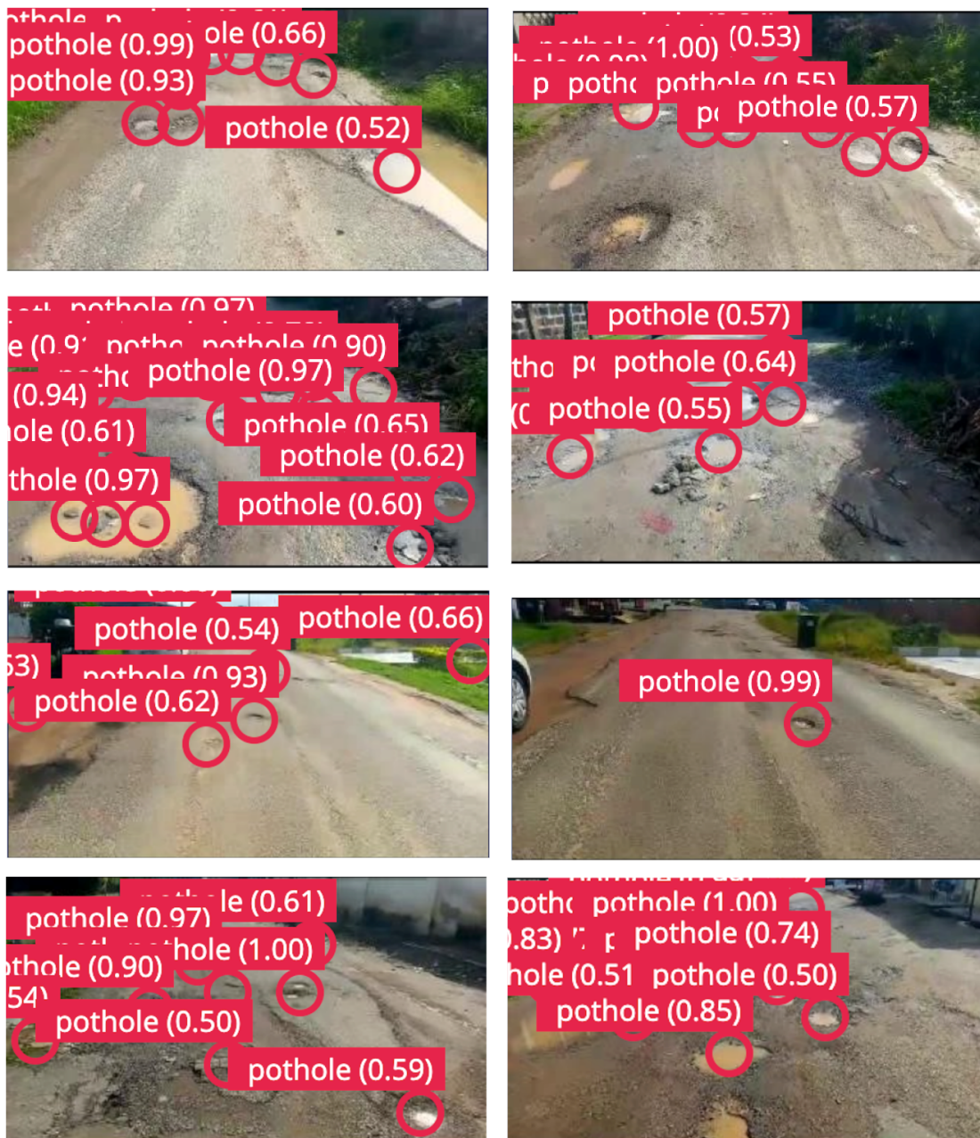
Figura 5.1: Predições de validação com modelo FOMO após treinamento
