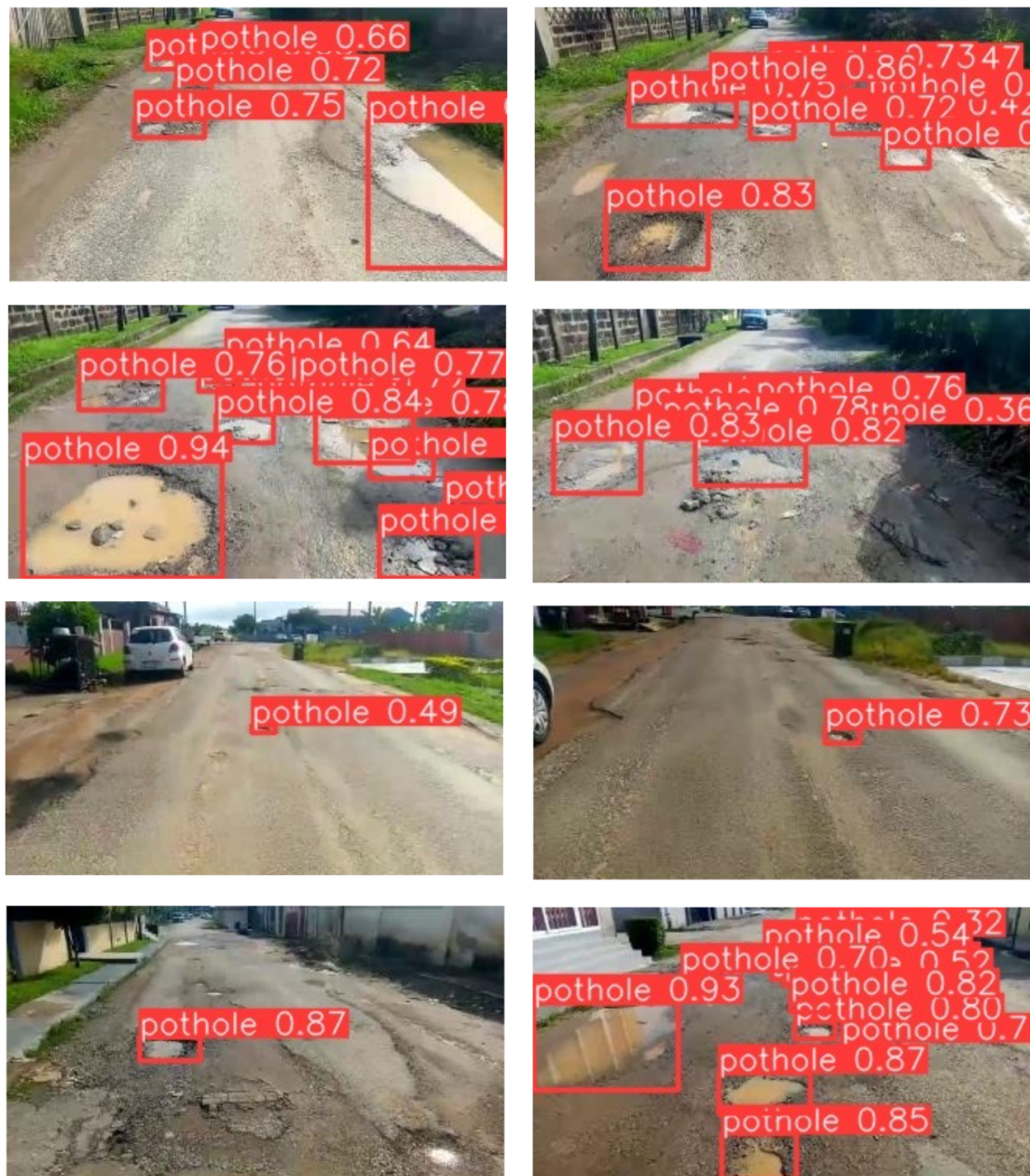
Figura 5.2: Predições de validação com modelo YOLOv8n após treinamento
