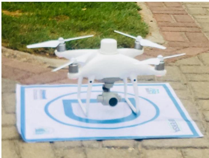
Figura 11 – VANT utilizado na aquisição das aerofotografias
