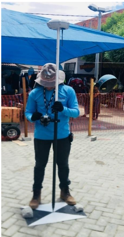
Figura 13 – Coleta de ponto geodésico em um alvo artificial fotoidentificável com rover
