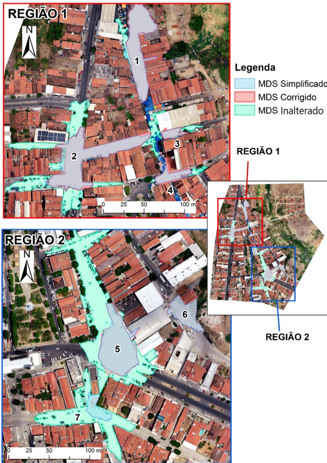
Figura 26 – Delimitação das depressões topográfica segundo os modelos utilizados em duas zonas de detalhes: REGIÃO 1 e REGIÃO 2
