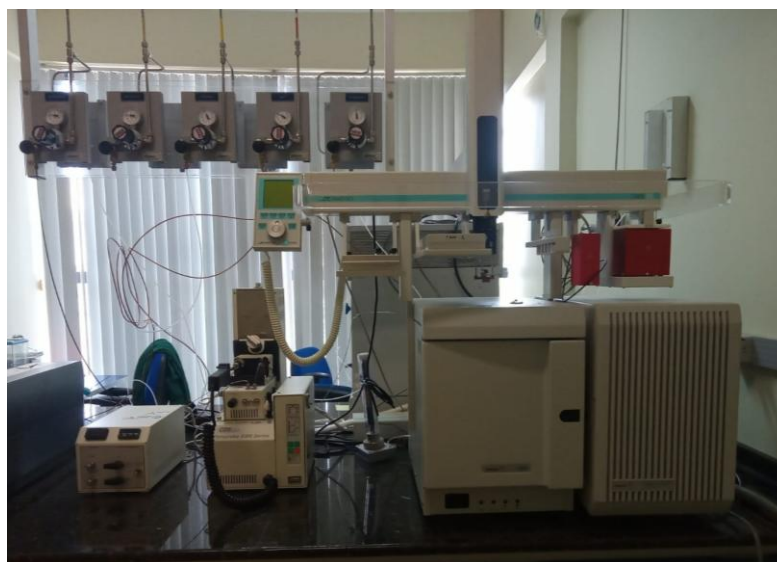
Figura 8. Equipamento Py-GC/MS (micropirolisador acoplado a cromatógrafo e espectrômetro de massa) utilizado na realização das pirólises analítica e catalítica.
