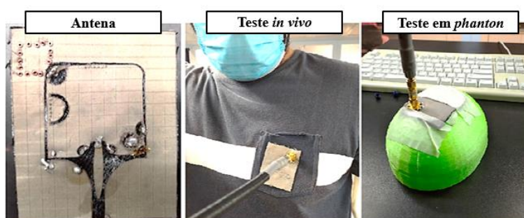
Figura 12: Antena têxtil com GCPW e SIW para monitoramento de câncer de mama.
