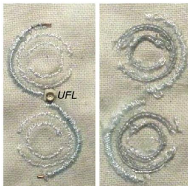
Figura 31: Antena SRR multibanda alimentada por um conector UFL.
