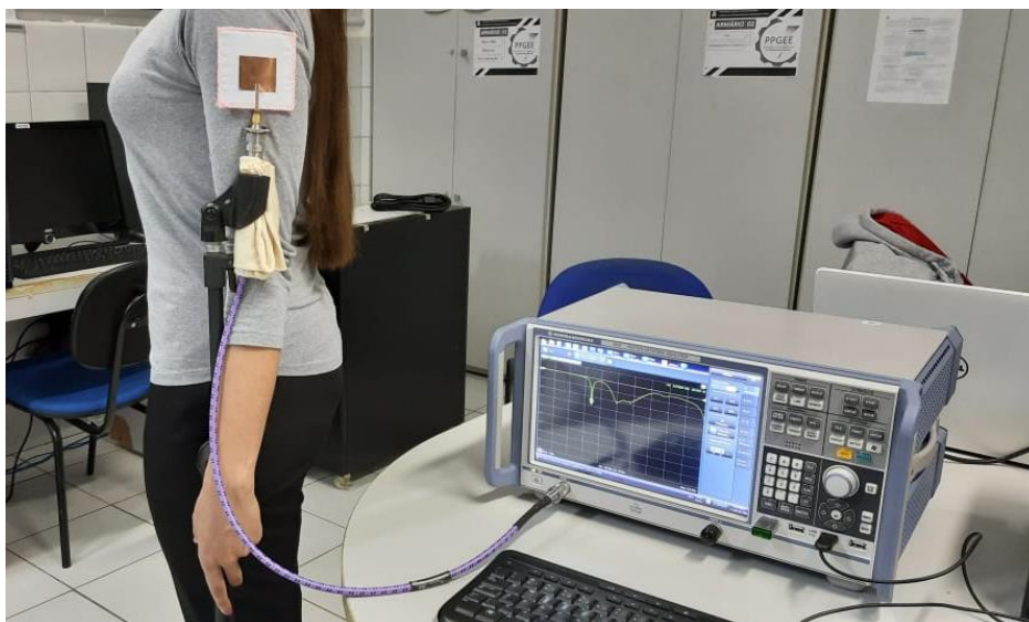
Figura 72: Medições das antenas próximas ao corpo.
