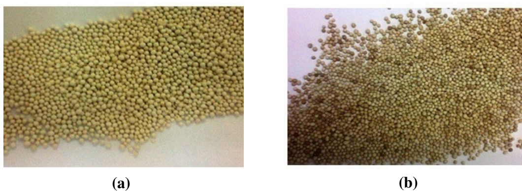
Figura 24 – Aspecto da zeólita 13X no processo de adsorção com os gases de pirólise. (a) antes e (b) depois
