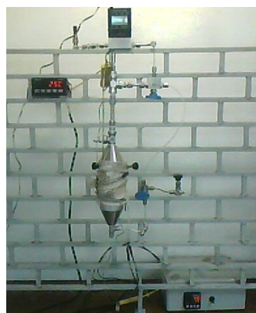
Figura 9 – Dispositivo experimental utilizado no processo dinâmico de adsorção em leito fixo
