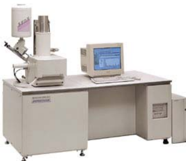
Figura 10: Microscópio eletrônico de varredura (MEV), modelo SSX-550 da Shimadzu com espectrômetro por energia dispersiva (microanálise) acoplado.
