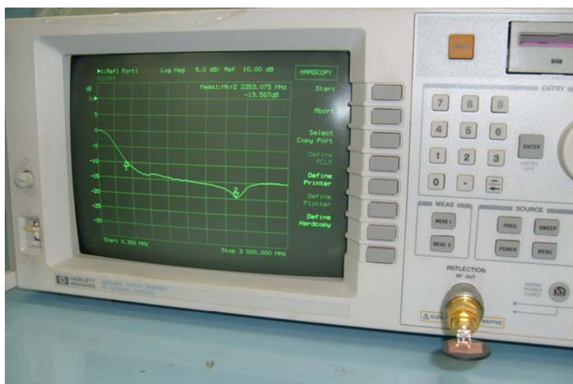
Figura 12: Analisador de redes modelo HP 8714C.
