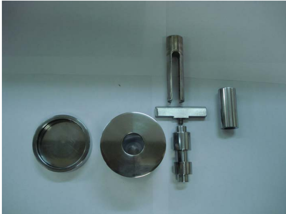
Figura 16: Matriz de aço ferramenta utilizada na conformação dos toróides.
