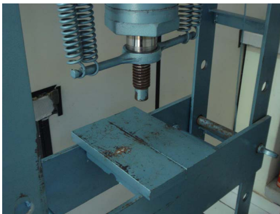
Figura 15: Prensa hidráulica utilizada para a compactação dos toróides.
