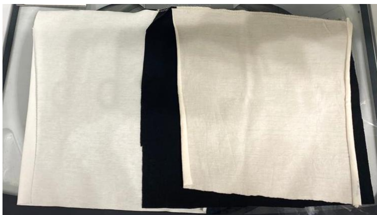
Figura 17 - Teste de solidez (à direita, pode-se ver uma testemunha já manchada por migração)
