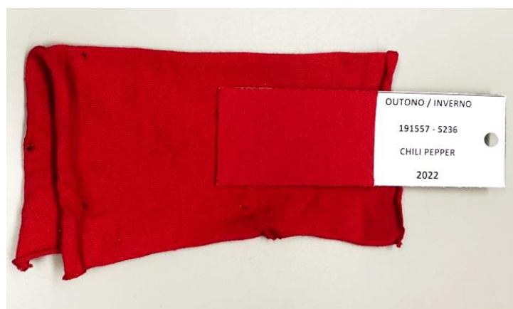
Figura 30 - Amostra tingida com concentração de corantes ajustada.
