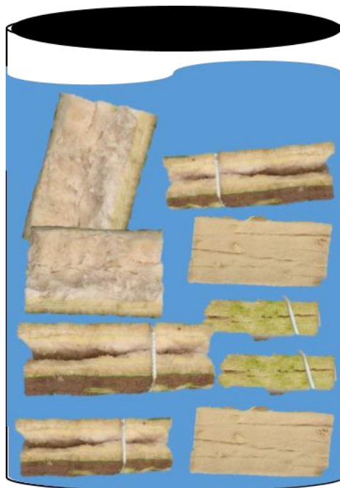
Figura 15. Recipiente hermeticamente fechado em condições especiais para a extração da fibra do mamoeiro por ação biológica
