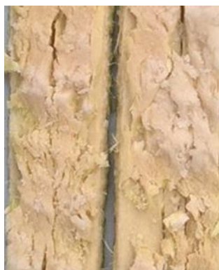
Figura 13. Caule batido antes (BTD) do processo de extração das fibras do mamoeiro por processo biológico.
