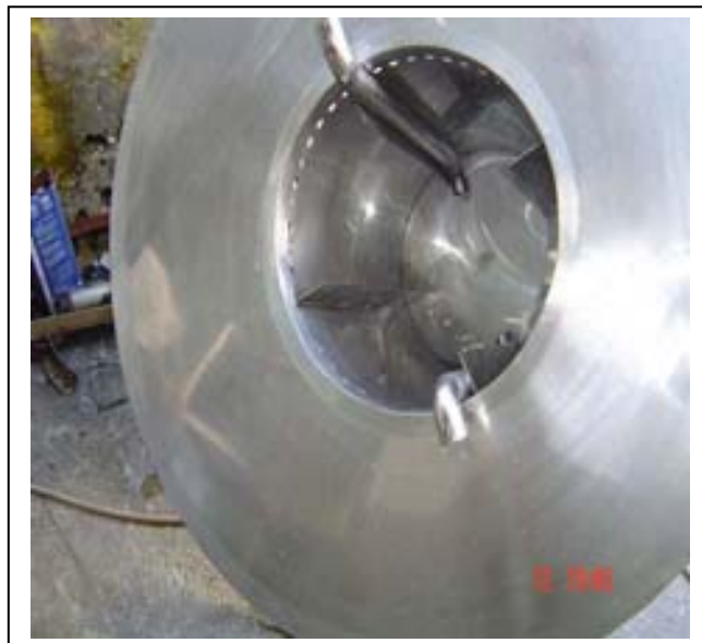
Figura 4.8: Reator da Câmara de Mistura em construção.
