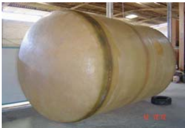
Figura 4.6: Vaso de armazenagem do orgânico em construção.
