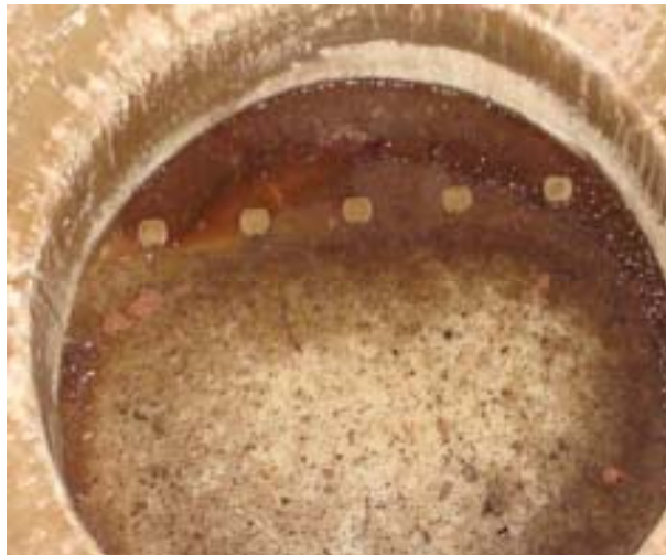
Figura 5.21. Prato perfurado sujo da coluna da UT-MDIF.
