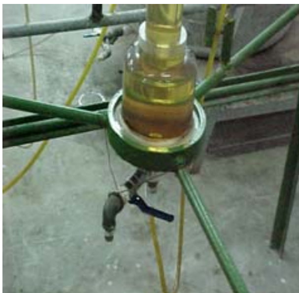
Figura 4.4. Tomada de amostra na saída de água tratada do MDIF.
