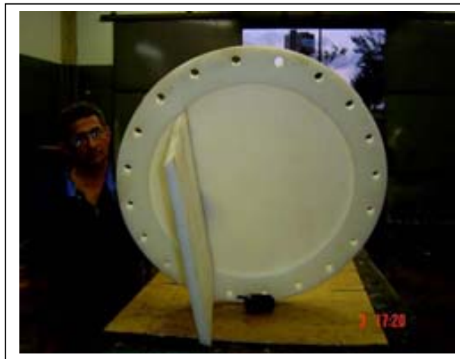
Figura 4.9: Prato perfurado em construção.
