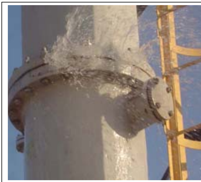
Figura 4.18: Teste hidrostático das linhas e equipamentos do processo.
