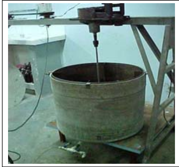
Figura 4.5. Tomada de amostra da água oleosa na saída do tanque.
