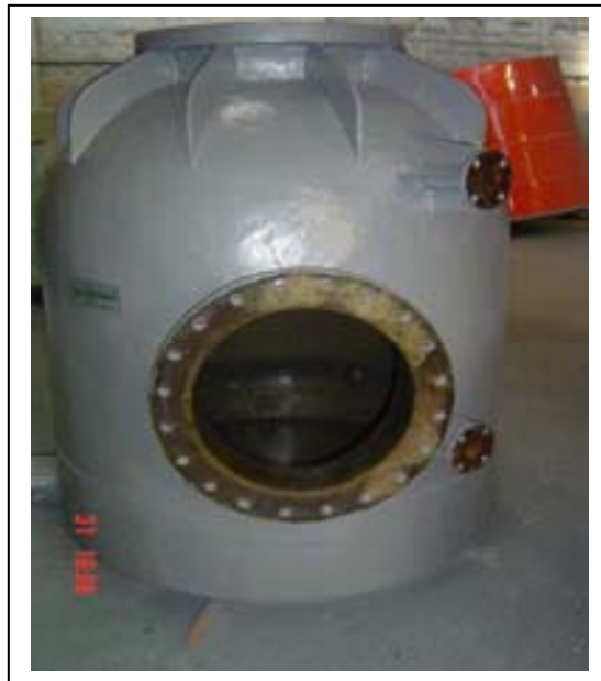
Figura 4.7: Câmara de Separação em construção.
