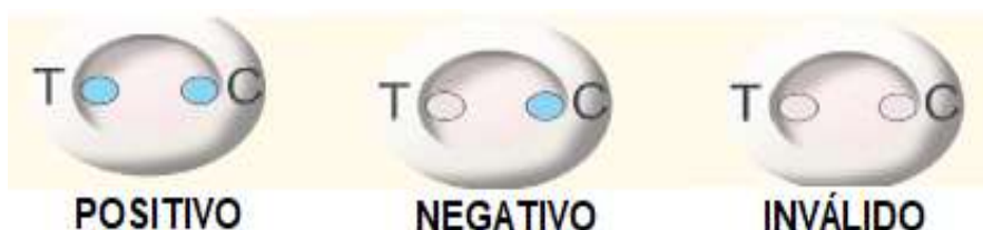
Figura 10: Representação esquemática dos possíveis resultados para o teste por Imunoconcentração .
