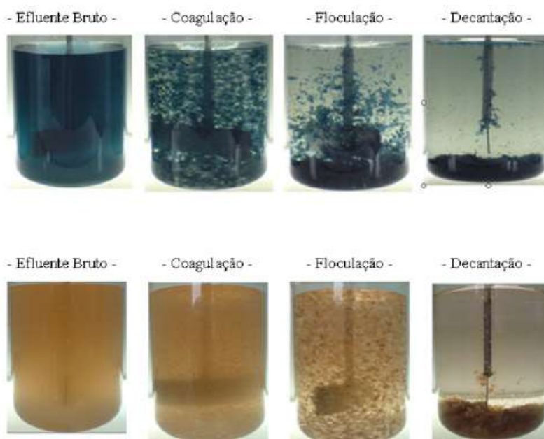
Figura 4 - Processo de coagulação e floculação
