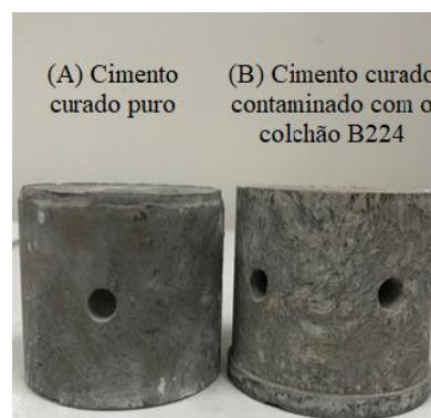
Figura 32 - (A) imagem da morfologia da pasta de cimento pura e (B) da pasta de cimento misturada com colchão lavador formulado com a mistura de surfactantes (B224).
