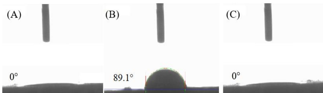
Figura 18 - Ângulo de contato para (a) pastilha de carbonato sem nenhuma contaminação ou tratamento, (b) pastilha contaminada com fluido de perfuração e (c) pastilha contaminada com fluido e tratada com a formulação SMA(B)10.
