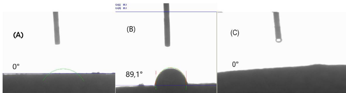
Figura II.4: Ângulo de contato imediato da gota de água na superfície da rocha para (a) pastilha de carbonato sem nenhuma contaminação ou tratamento (b) pastilha contaminada com fluido de perfuração e (c, d, e, f e g) pastilha contaminada com fluido e tratada com a formulação de butanol 2% em solução de KCl 2% (m/v) na temperature de 30 °C.
