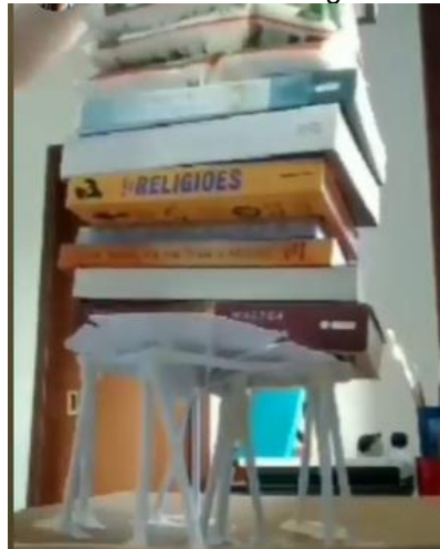
Figura 75: Foto do teste de carga do Modelo 6.
