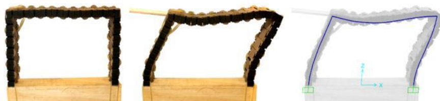
Figura 11: Comparação do modelo físico - carga horizontal x simulação digital.
