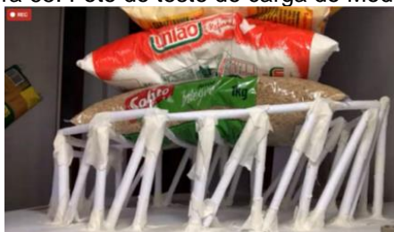
Figura 65: Foto do teste de carga do Modelo 1.
