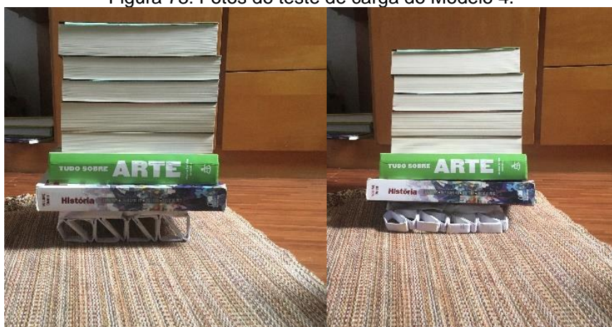
Figura 73: Fotos do teste de carga do Modelo 4.
