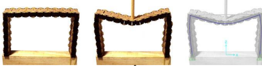
Figura 10: Comparação do modelo físico - carga vertical x simulação digital.
